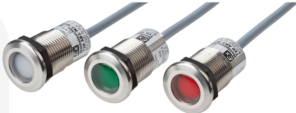
La lampe de signalisation AB1-M3 permet d'indiquer de manière fiable l'état des signaux sur les machines et les installations dans les zones à risque d'explosion, zone 1/2 et zone 21/22. Un IP élevé et le boîtier en acier inoxydable résistant à la corrosion garantissent une longue durée de vie, même dans des conditions environnementales agressives.
