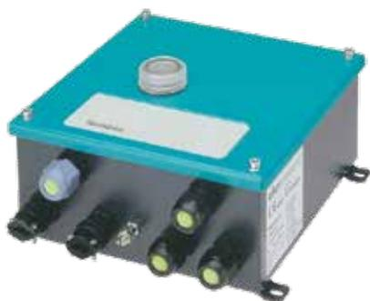
La Terrabox TCB030 est conçue pour permettre la connexion d'une pince dans les zones à risque d'explosion. Le témoin bicolore signale l'état correct de la mise à la terre. Les contacts intégrés permettent de mettre en place un circuit d'activation.
