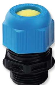
Presse-étoupe ATEX en Polyamide pour des installations à sécurité augmentée "e" (couleur noire RAL 9005) et pour des installations à sécurité intrinsèque "i" (couleur bleue RAL 5012).
