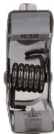
Ces pinces de mise à la terre sont spécialement conçues pour décharger la charge électrostatique des parties du système potentiellement dangereuses. Grâce à la pression élevée du ressort, les dents en acier inoxydable traversent les couches isolantes telles que la peinture, la rouille, la saleté et la graisse. De cette manière, une connexion "métal sur métal" efficace peut être créée et une mise à la terre sûre garantie.
