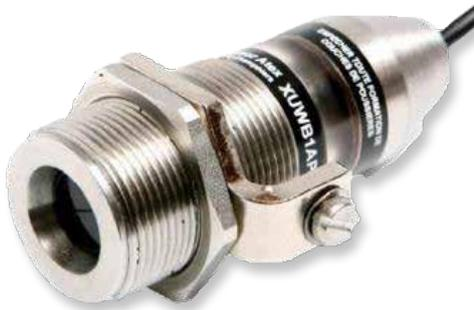
Cellule photoélectrique Antidéflagrante - Groupe IIC gamme XUWB. Avec un encombrement de seulement 30 mm de diamètre cette cellule photoélectrique pré-câblée, certifiée ATEX Ex d, peut être utilisée dans tous types d'applications et process.
