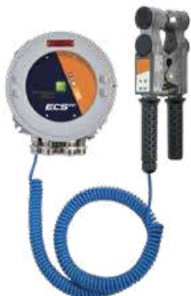
Les équipements électroniques de la série ECS-RF assurent la mise à la terre des équipements (camions-citernes, fûts, GRV, etc.) avec une surveillance en temps réel de la mise à la terre. Le système surveille que la connexion à la terre est obtenue avec une résistance inférieure à 10Ω, conformément à la directive ATEX 2014/34/UE.
