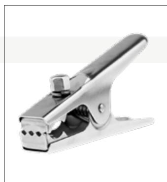
Ces pinces de mise à la terre sont spécialement conçues pour décharger la charge électrostatique des parties du système potentiellement dangereuses. Grâce à la pression élevée du ressort, les dents en acier inoxydable traversent les couches isolantes telles que la peinture, la rouille, la saleté et la graisse. De cette manière, une connexion "métal sur métal" efficace peut être créée et une mise à la terre sûre garantie.
