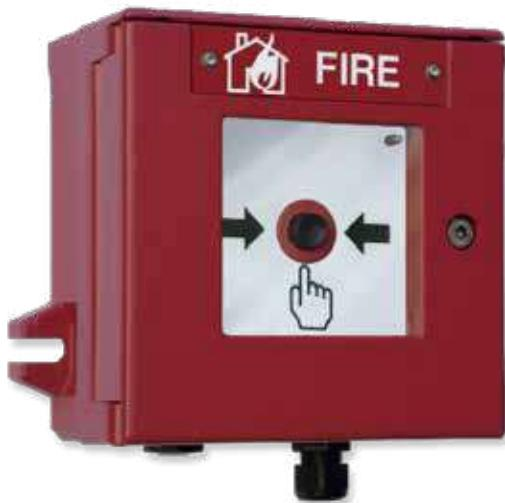
Ce déclencheur manuel d'alarme permet de donner le signal d'évacuation lorsqu'il est actionné. Il peut être relié à une centrale d'alarme afin de mettre en marche les diffuseurs sonores qui donnent le signal d'évacuation. Déclencheur manuel de type B conformément à la norme EN 54-11 ou alarme spéciale conformément à la norme EN 12094/EN 12094-1.
