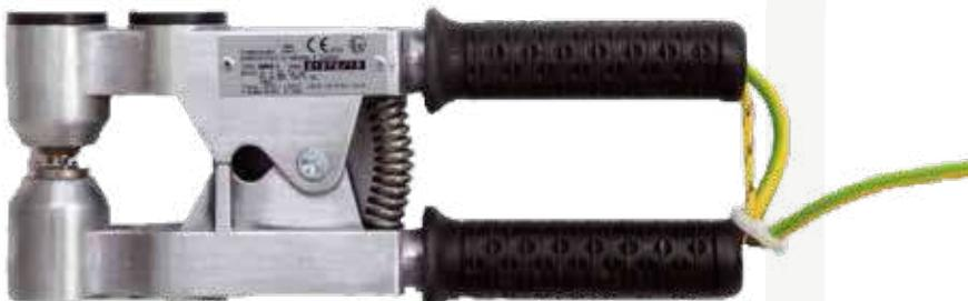
La continuité électrique est assurée par contacts d'acier carbonitruré, qui établissent une connexion ferme avec n'importe quel pied d'appui avec une épaisseur comprise entre 3 et 20mm.
