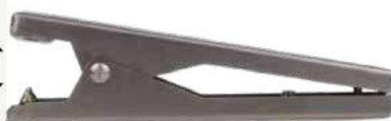
Ces pinces de mise à la terre sont spécialement conçues pour décharger la charge électrostatique des parties du système potentiellement dangereuses. Grâce à la pression élevée du ressort, les dents en acier inoxydable traversent les couches isolantes telles que la peinture, la rouille, la saleté et la graisse. De cette manière, une connexion "métal sur métal" efficace peut être créée et une mise à la terre sûre garantie.
