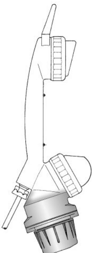
Un générateur d'appel électromagnétique actionné manuellement génère un courant d'oscillation d'une fréquence d'environ 2000 Hz, qui est transmis directement à la capsule réceptrice par l'intermédiaire d'un câble à deux fils.
