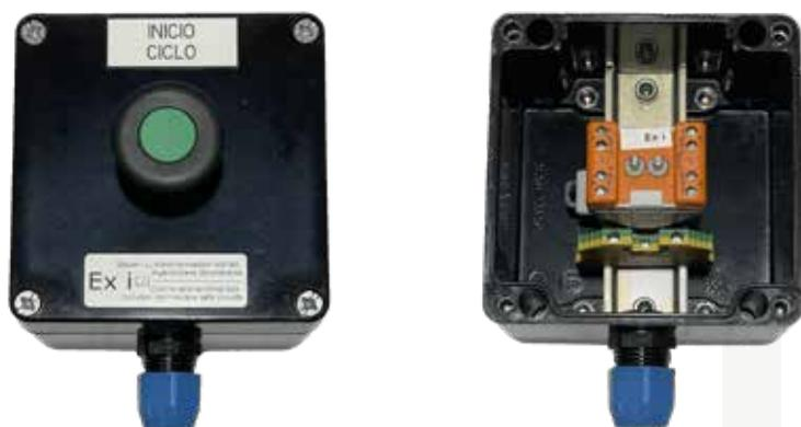
Boîtes à boutons Ex i équipées d'un bouton de type coup de poing, en polyester renforcé de fibres de verre, pour utilisation en atmosphères explosives, exclusivement dans des circuits à sécurité intrinsèque.
